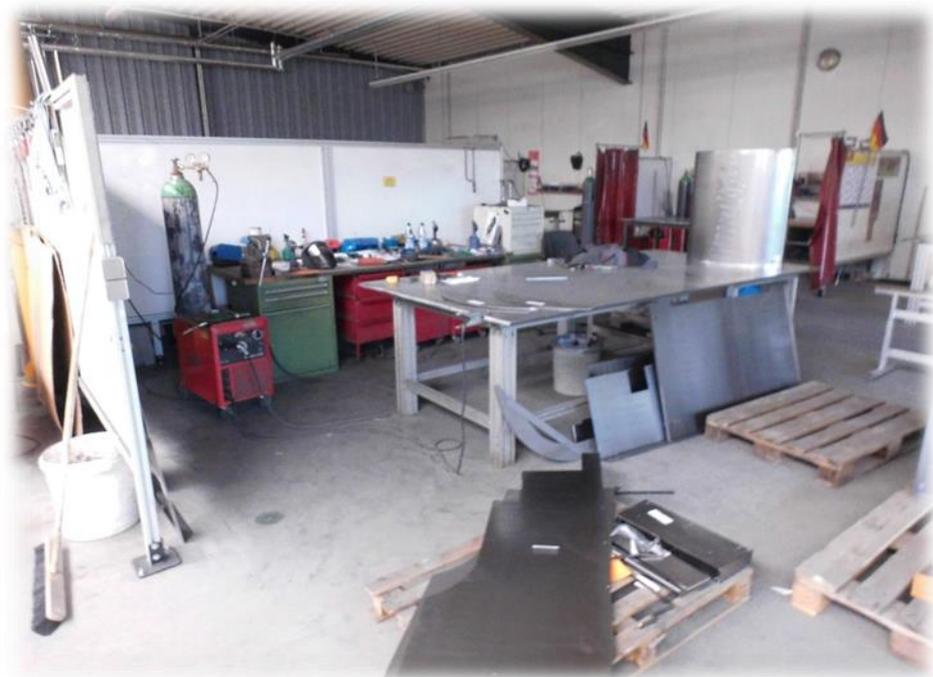
Vorher: Der Bediener am Laser muss selber die entsprechenden Materialien kommissionieren. Das Handling erfolgt über Stapler und Paletten in 2 „Etagen“
